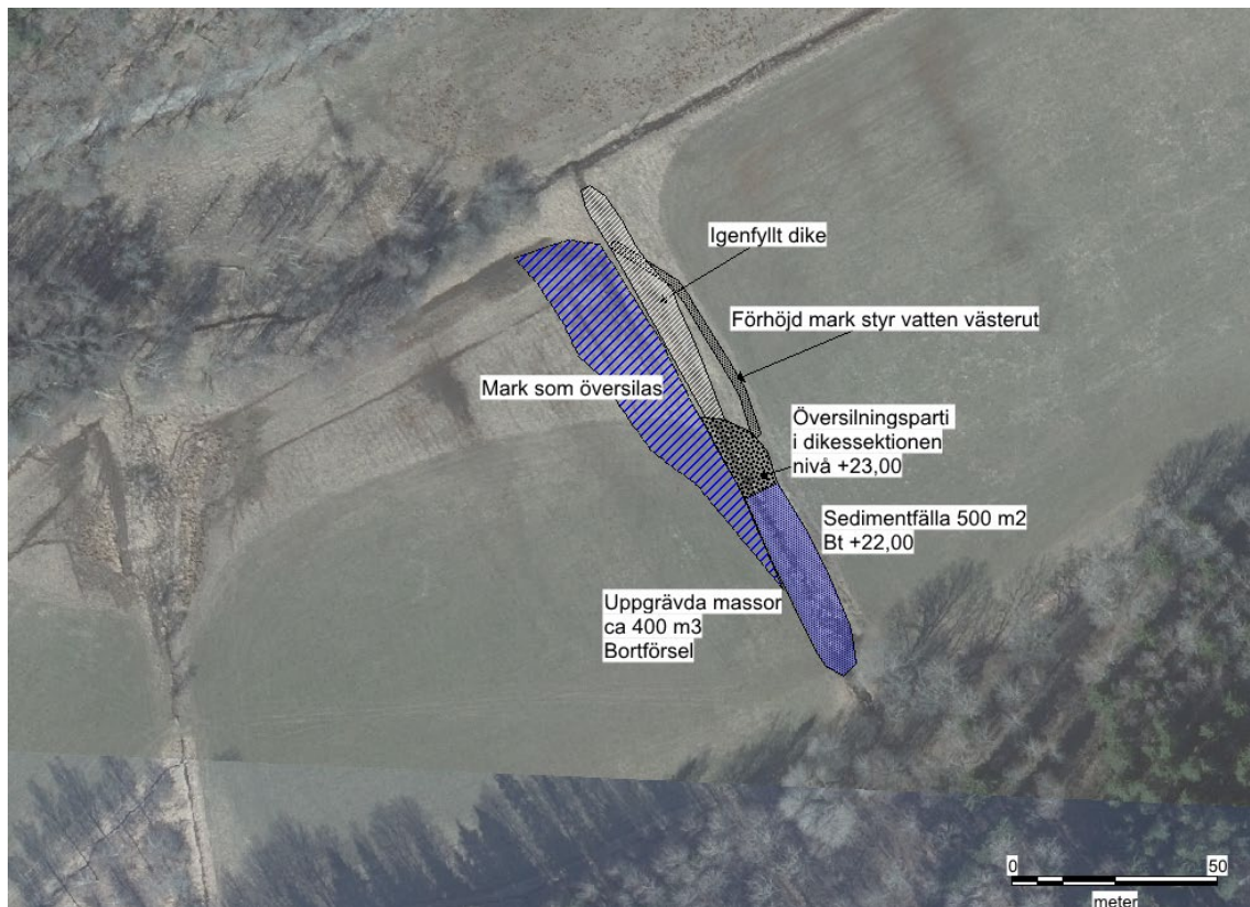
Figur 31. Föreslagen sedimentfälla och översilningsområde för rening av vatten från Gladö industriområde.
