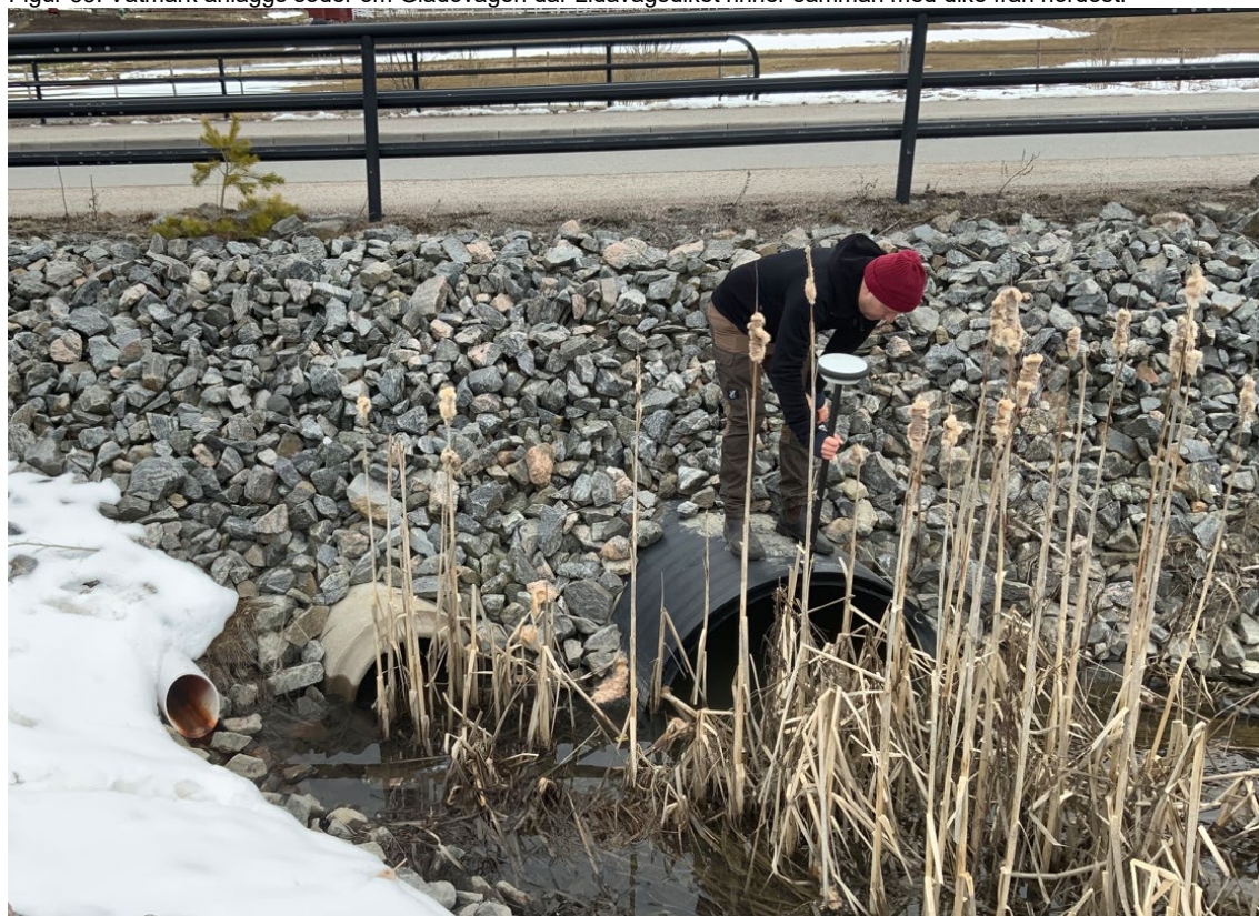
Figur 34. Inmätning av vägtrummor där Lidavägsdiket korsar Gladövägen (2023-04-05)
