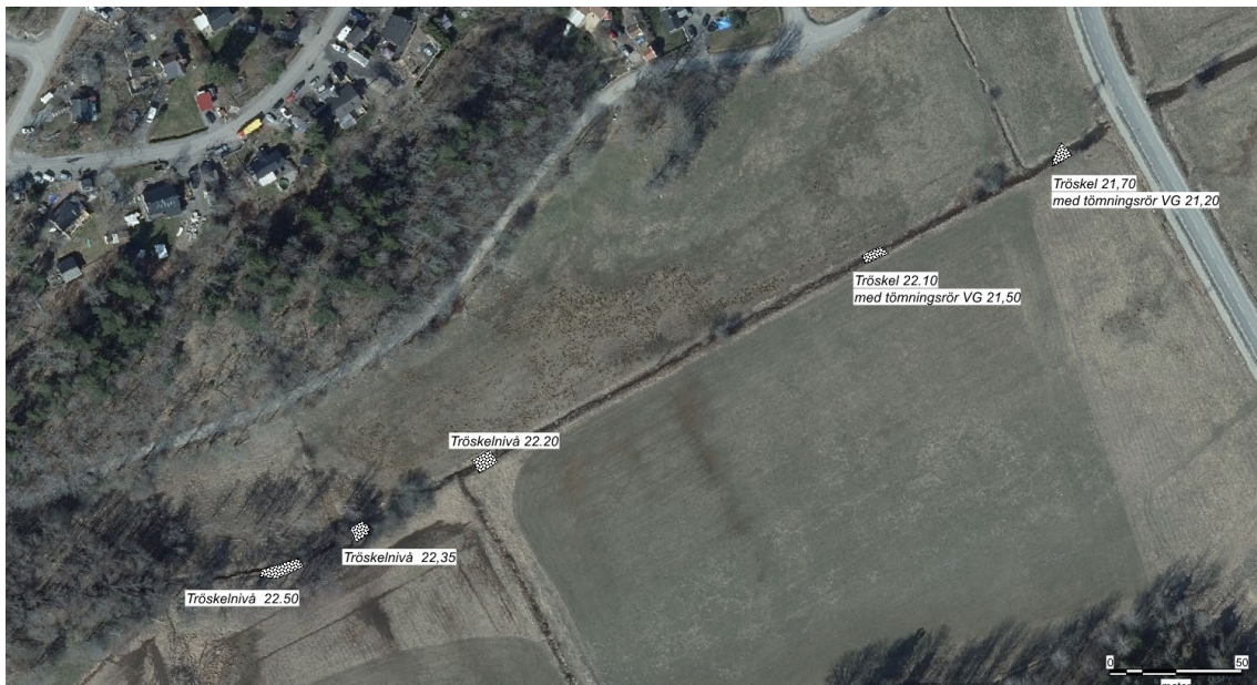
Figur 23. Läge och nivå för 5 planerade trösklar i Ebbadalsdiket.
