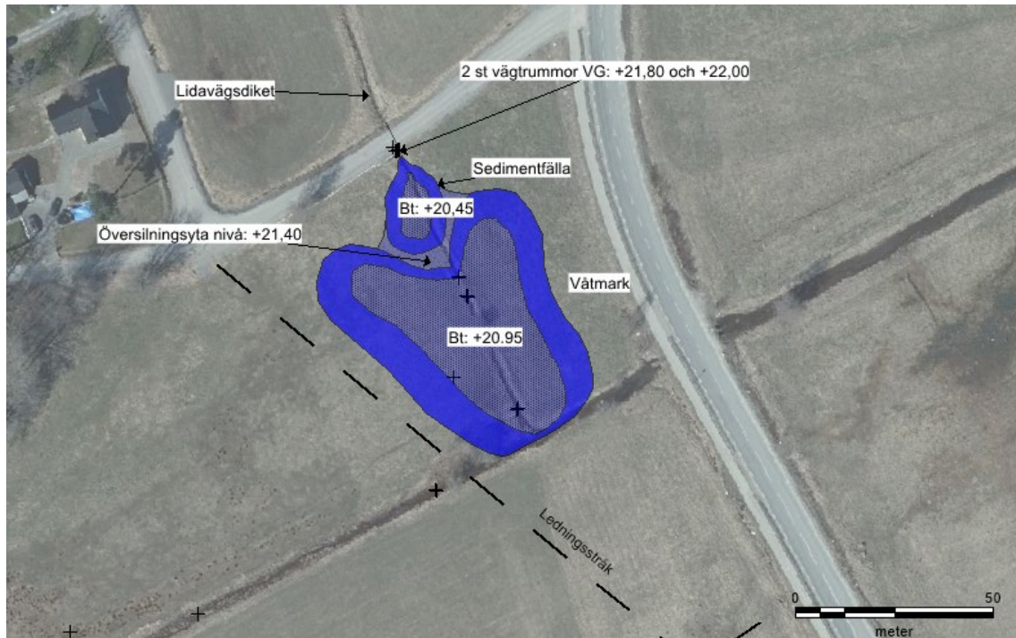
Figur 29. Våtmark med tre bottennivåer anläggs i Lidavägsdiket före dess anslutning till Ebbadalsdiket
