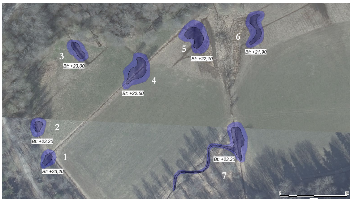
Figur 28. Platser, form och bottennivå för småvatten och meanderbågar i västra området. Siffrorna hänvisar till respektive post i Tabell 12.
